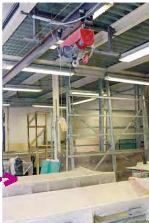
Un pont roulant a été aménagé dans l'atelier et permet une manutention aisée des charges.
